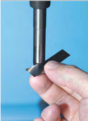
Abb. 4: Fühlerlehre darf NICHT in Verbindungslücke passen
