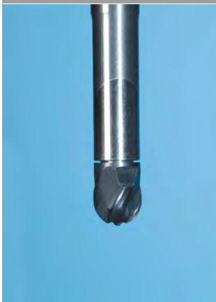
Abb. 2: Luftspalt in der Verbindungslücke
