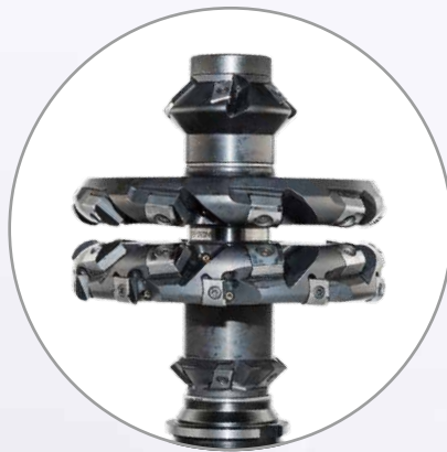
Satzfräser für die Bearbeitung der Anschlusslaschen.
