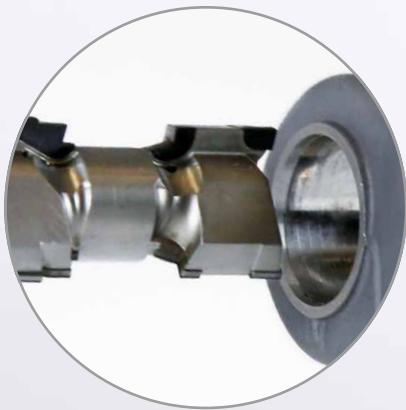
PKD-gelötetes Werkzeug zur Buchsenbearbeitung.
