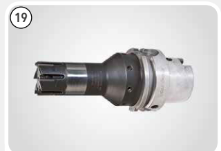
19 Schlichtbohren Finish boring
